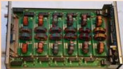
Le Filtre passe-bande OM6BPF est conçu pour toutes les bandes amateurs de 1,8 jusqu'à 29 MHz avec 200 W de puissance.
